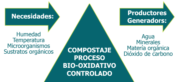
Figura 34. Esquema simplificado del proceso de compostaje
